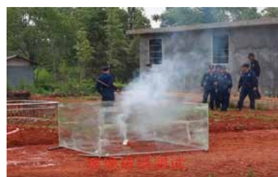
消防弹对0.5cm玻璃无破坏
