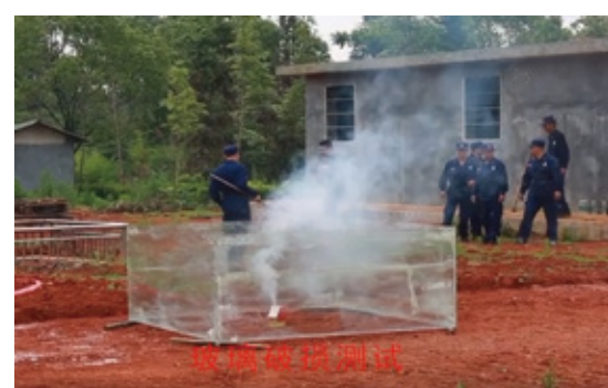
消防弹对0.5cm玻璃无破坏
